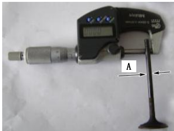
A. Valve Stem Diameter
