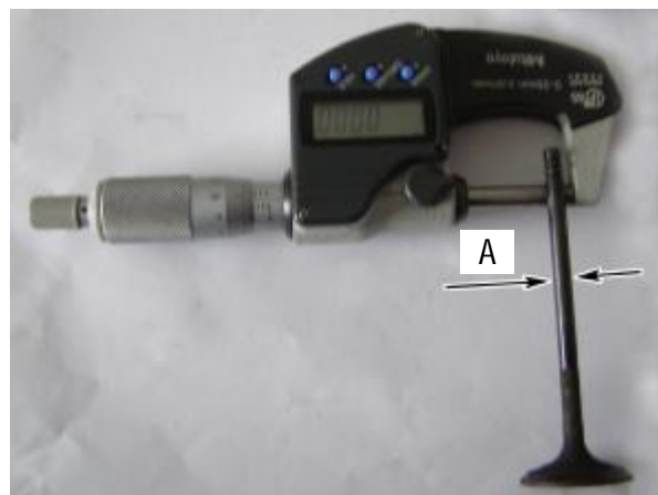
A. Valve Stem Diameter
